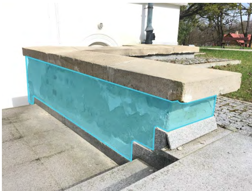
Rysunek 3. Schemat naprawy tynku przy schodach - nowa powłoka tynkarska
