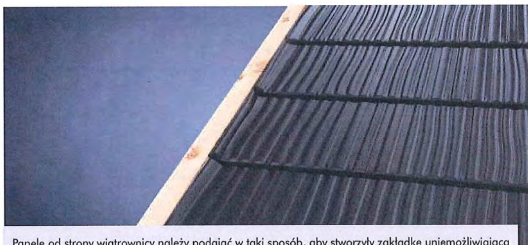
Panele od strony wiatrownicy należy podgiąć w taki sposób, aby stworzyły zakładkę uniemożliwiającą przedostawanie się wody i zanieczyszczeń pod wiatrownicę.
